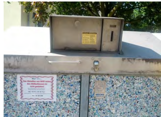
Abb. 7: Beispiel für eine Müllschleuse mit Identensystem bei der Wohnungsgenossenschaft „Elbtal“ Heidenau, Deutschland (Foto: S. Guerrero Mercado)
